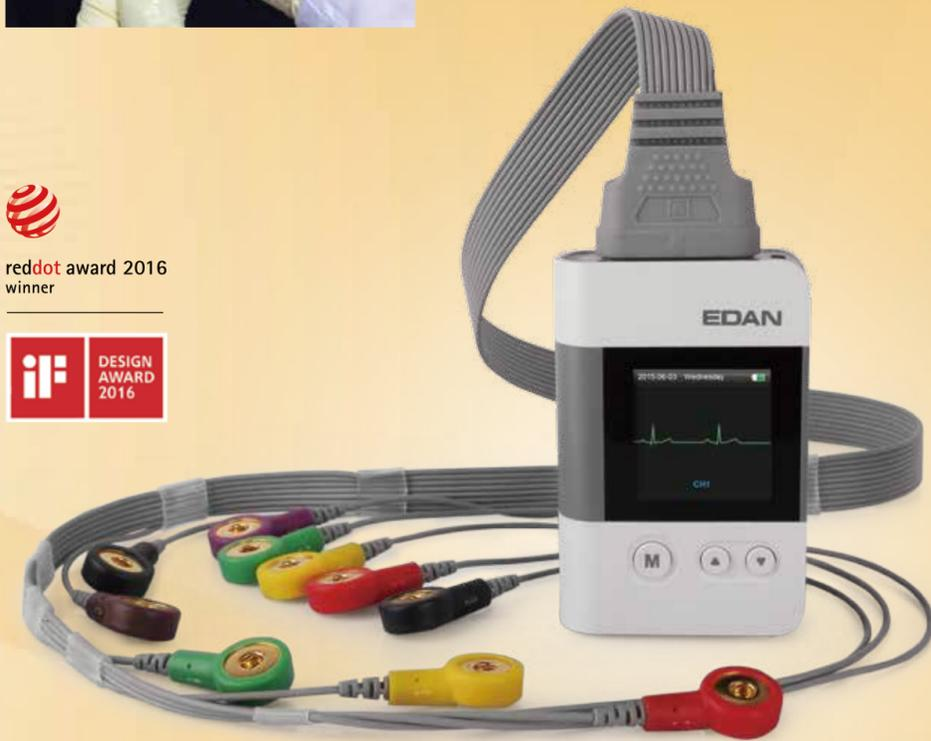
La grabadora Holter de EDAN tiene una arquitectura de bajo consumo de energía, que le permite grabar datos hasta por 8 días por carga; esto, gracias a su batería recargable de Ión de Litio.
